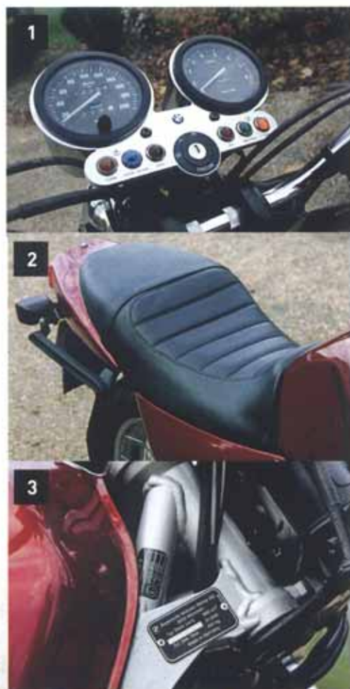
1. Le tableau de bord avec ses deux gros cadrans à fond noir et aiguilles est très classique. Une batterie de voyants souligne les instruments de part et d'autre du contacteur. 2. Avec sa selle creusée et plus basse, la Mystic est plus accessible. La faible épaisseur de la mousse grève le confort général. La place du passager n'est pas très enviable. Pour une balade, pas plus... 3. La plaque d'identification du modèle indique R 100 R. 4. Le 980 cm 3 à air développe 60 ch et 7,8 mkg de couple. Placide, solide, il n'est pas si rapide (180 km/h environ). Les caches culbuteurs chromés sont une option retenue des R 100 R édition limitée. 5. Le mono bras oscillant accueille des jantes à rayons tangentiels. 6. Pour cacher le moyeu arrière, cette soucoupe chromée est un accessoire d'époque. 7. Ce tuyau qui va du boîtier de filtre à air jusqu'à la culasse côté échappement est chargé de la dépollution des gaz d'échappement. 8. Le train avant est équipé d'un double disque Brembo, d'origine.
