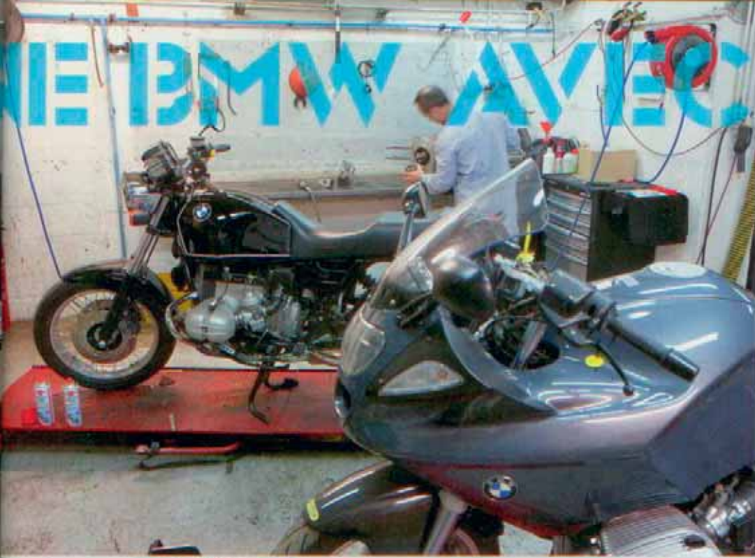
Le préparateur dans ses œuvres, en train de parfaire les conduits d'échappements après avoir remodelé ceux d'admission.
